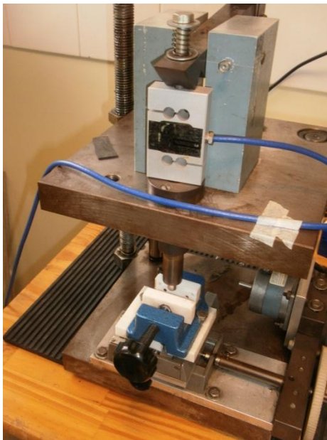
Figura 48. Vista del equipo de “ scratch test ” y detalle de la probeta con el sensor de EA.
