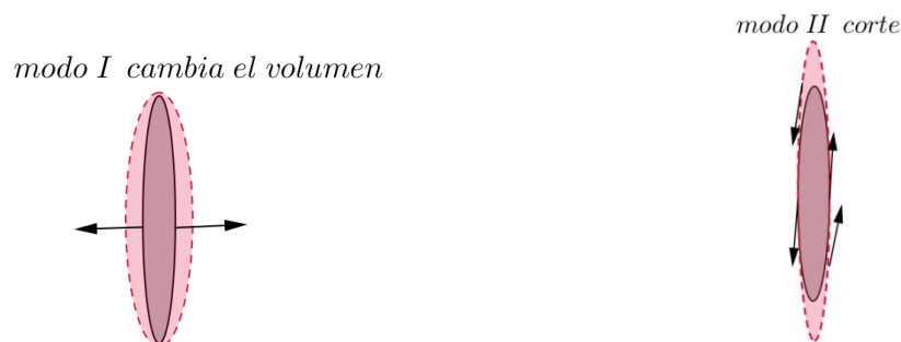
Figura 22. Dos posibles modos de rotura.
