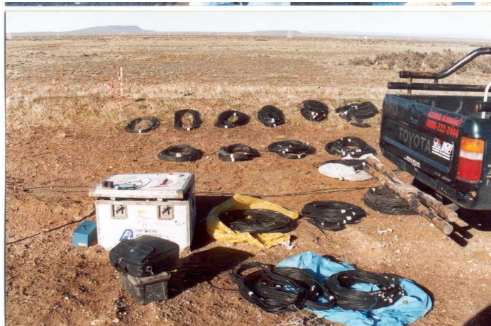
Figura 42. Preparativos para la realización de un ensayo de EA en una tubería.
