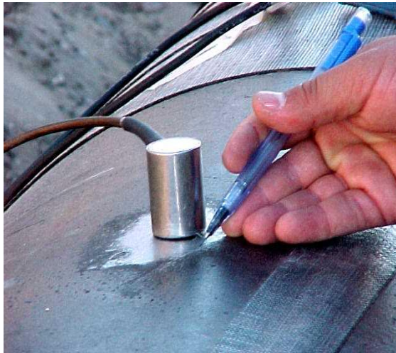
Figura 43. Verificación del buen funcionamiento de los canales de EA, mediante la rotura de la mina de lápiz.
