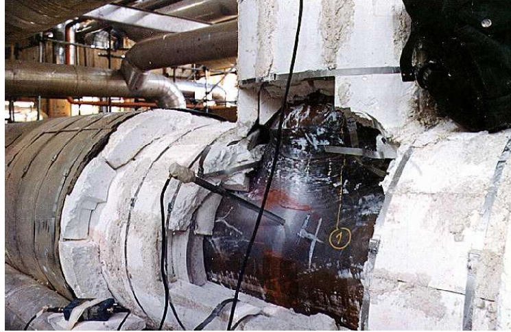
Figura 41. Se observa un sensor de EA con su guía de onda a temperatura de 300°C.
