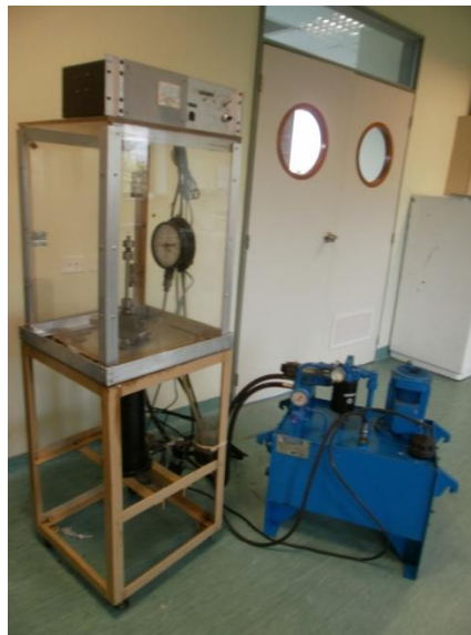
Figura 46. Sistema hidráulico construido y central de presurización.
