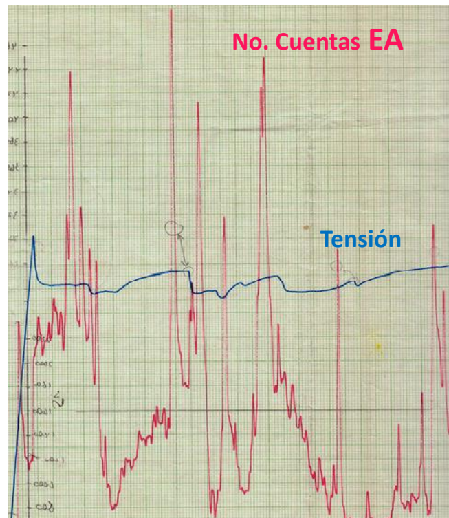
Figura 18. Detalle de la zona de deformación inhomogénea, en un acero de bajo C.
