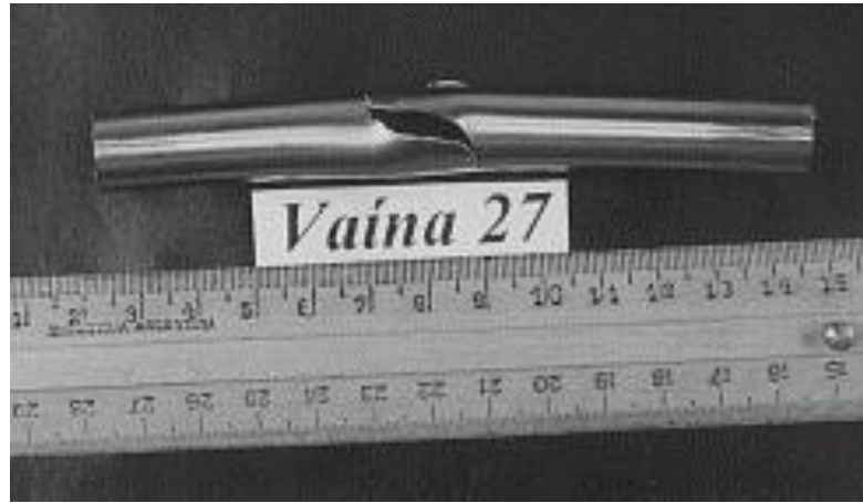
Figura 47. Fotografía de un tubo de Zry llevado hasta la rotura.
